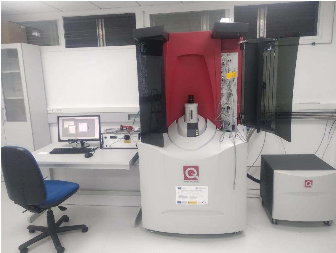
Magnetómetro de tecnoloxía SQUID con sistema de funcionamento en ciclo pechado (cryogen-free evercool system).
