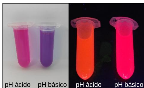
Figura 2. Comportamento ácido-base dun fluoróforo observado baixo luz natural (esquerda) e luz ultravioleta (dereita).
