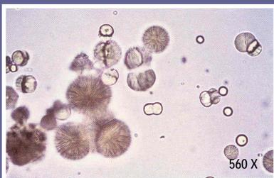
CRISTALES DE CARBONATO CALCICO (forma radial concéntrica) 560 X
